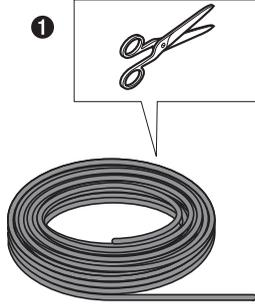
$\varnothing 2,0 \text{ mm} = \text{---} 3,6 \text{ m} \text{---}$
